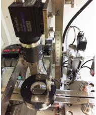
また、2019年の6月より、自動選別機VS-Liner100(株式会社オオシマ設備製)を導入、検品・出荷工程を高度化いたしました。これにより、自動選別機を用いての納品を、従来の目視選別での納品とは一線を画しくSサプライヤーサービス>の名称で実施しております。 異物・異品混入のリスクを低減し、格段に納品クオリティを向上させた自動選別ラインとくSサプライヤーサービス>に関するお問い合わせは、弊社・営業部にてお承りいたします。
